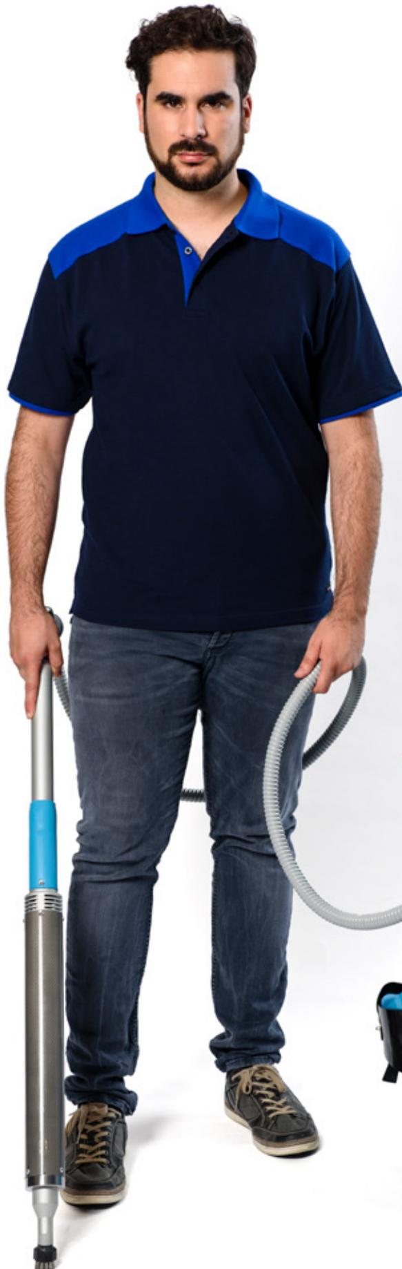
Uma mochila confortável e autónoma é usada pelo operador, permitindo uma completa liberdade de movimentos e fácil usabilidade. O equipamento está conectado a uma lança ergonómica desenvolvida especificamente para garantir operação rápida, fiável e fácil com remoção máxima da pastilha.
