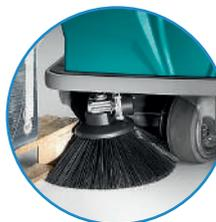
Escova central ajustável de fácil e rápida substituição.
