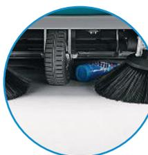
Aspirador incorporado (opcional) permite a limpeza de inacessíveis à máquina principal.
