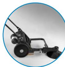
Escova lateral ajustável, antichoque, permite varrer os cantos e ao longo das paredes.
